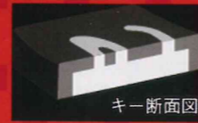
キー断面図 通常の印刷仕上げとは異なり 長期間の使用でも数字が消え ない2色成型仕上げ。 (一部キーを除く)
